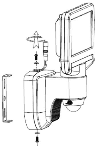
3. Fije el soporte en la zona donde vaya a ir instalado el proyector con tacos y tornillos.
